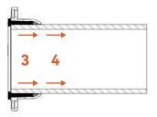
1) TIGHTEN TWO FLANGES 2 GASKETS ARE PUSHED TOWARD THE PIPE 3) GASKET MOVED TOWARDS THE NARROW PART IN THE AHEAD OF QUICK FLANGE ADAPTOR TO BE SQUEEZED TO ACHEVE SEALING AROUND THE PIPE.
